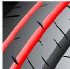
**INNOVATIVES „LEISES“ RILLENPROFIL** verringert den Luftwiderstand durch Verzahnungen und reduziert so die Außengeräusche
